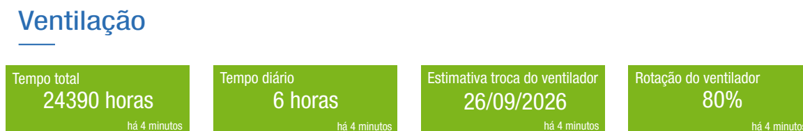
Figura 8.7: Indicações relacionadas a saúde dos ventiladores
