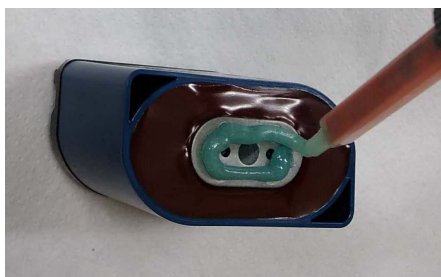
(a) Aplicación de adhesivo en la base del sensor
