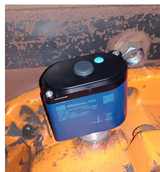
(b) Sensor instalado con soporte intermediario
