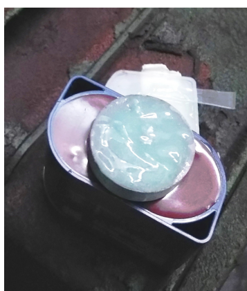
(b) Aplicación del adhesivo en el soporte
