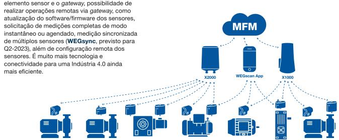
Notas: As características detalhadas de operação do Gateway X1000 e WEG Motor Scan no MFM são apresentadas no manual do MFM. A medição de espectro de vibração de modo remoto está disponível apenas no WEGscan.
